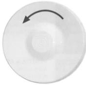
Повернуть тарелку вентиля из положения «щелчка» против часовой стрелки (по направлению к положению "открыто") примерно на пол-оборота.
